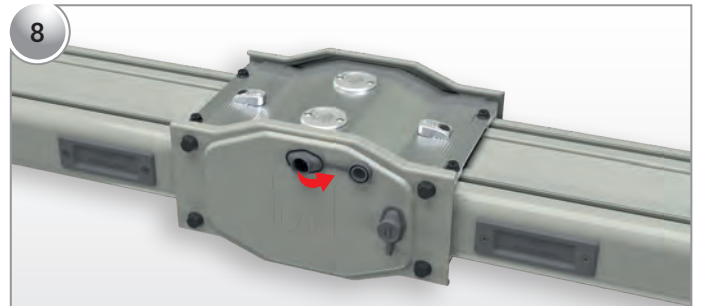
Döküm yapılacak bölgenin plastik kapağı açılır. Dikkat: Busbar duruş yönüne göre yukarıda olan plastik kapaktan dolum işlemi yapılır.
