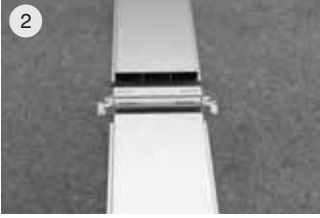
Kanalları birbirine ekleyiniz.
